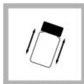
8. 将混合池盖紧，然后颠倒数次。溶液会变热。在继续操作之前，将其冷却至室温。
