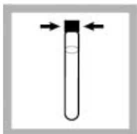
5. 盖上瓶盖并拧紧。用去离子水冲洗 COD 试剂瓶的外表，然后用纸巾将瓶子擦干净。
