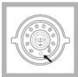
节 VPD 顶部的真空调节阀，直到内部的压力表读数到达 20 英寸
