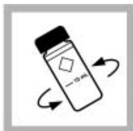
7. 将每个样品池盖紧，然后轻轻旋转三次以混合样品。
