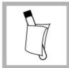
4. 用毛巾将实验空白的瓶外壁擦干净。
