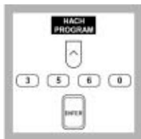
2. 按下 **HACH PROGRAM** 字样下的软按键。按数字键盘上的 **3560**，为三卤甲烷 (THM) Plus 法选择机器内存储的程序序号。
