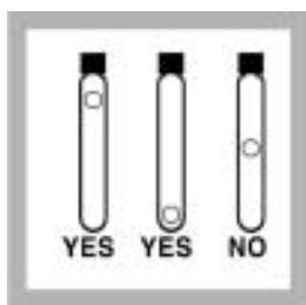
25. 如果已完成了氯化物去除过程，请确保过滤用的圆盘状物浮在试剂瓶的中部；它会干扰仪器的读数。轻轻晃动瓶子或轻轻地在桌面上移动。
