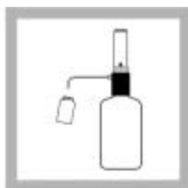
7. 使用自动加液器或 TenSette 移液管，往混合池内加入 1.0 mL 浓硫酸。
