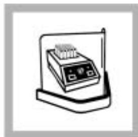
19. 将试剂瓶放入已预热到 150 的 COD 反应器中。消解 1 小时。
