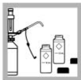
15 使用 Jr 移液管往样品池及空白中加入 1 mL 的 THM Plus 3 试剂。旋转以混合。
