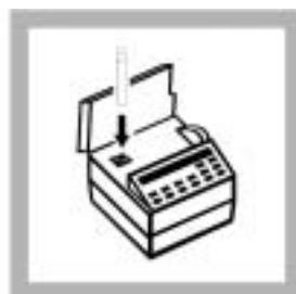
23. 将空白样放入样品池的插槽中。将盖子盖在插槽上。
