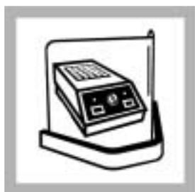
1. 将 COD 反应器放在通风橱中，并将塑料防护屏放在反应器前面。
