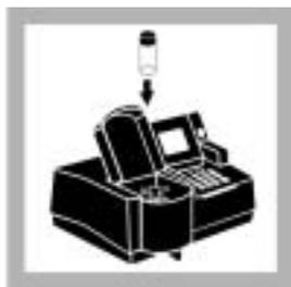
26. 将准备好的水样放入样品池插槽中，然后盖上盖板。测量结果将以 ppb 三氯甲烷的单位显示在屏幕上。
