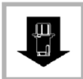
3、将 16-mm 试管匣安装入测试箱。放入空白样。
