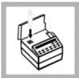
5. 将空白放入插槽中，让瓶上的 Hach 标志正对着仪器的前部。把盖子盖在该插槽上。
