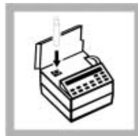
8. 将样品瓶放入插槽中，让瓶上的 Hach 标志正对着仪器的前部。把盖子盖在该插槽上。
